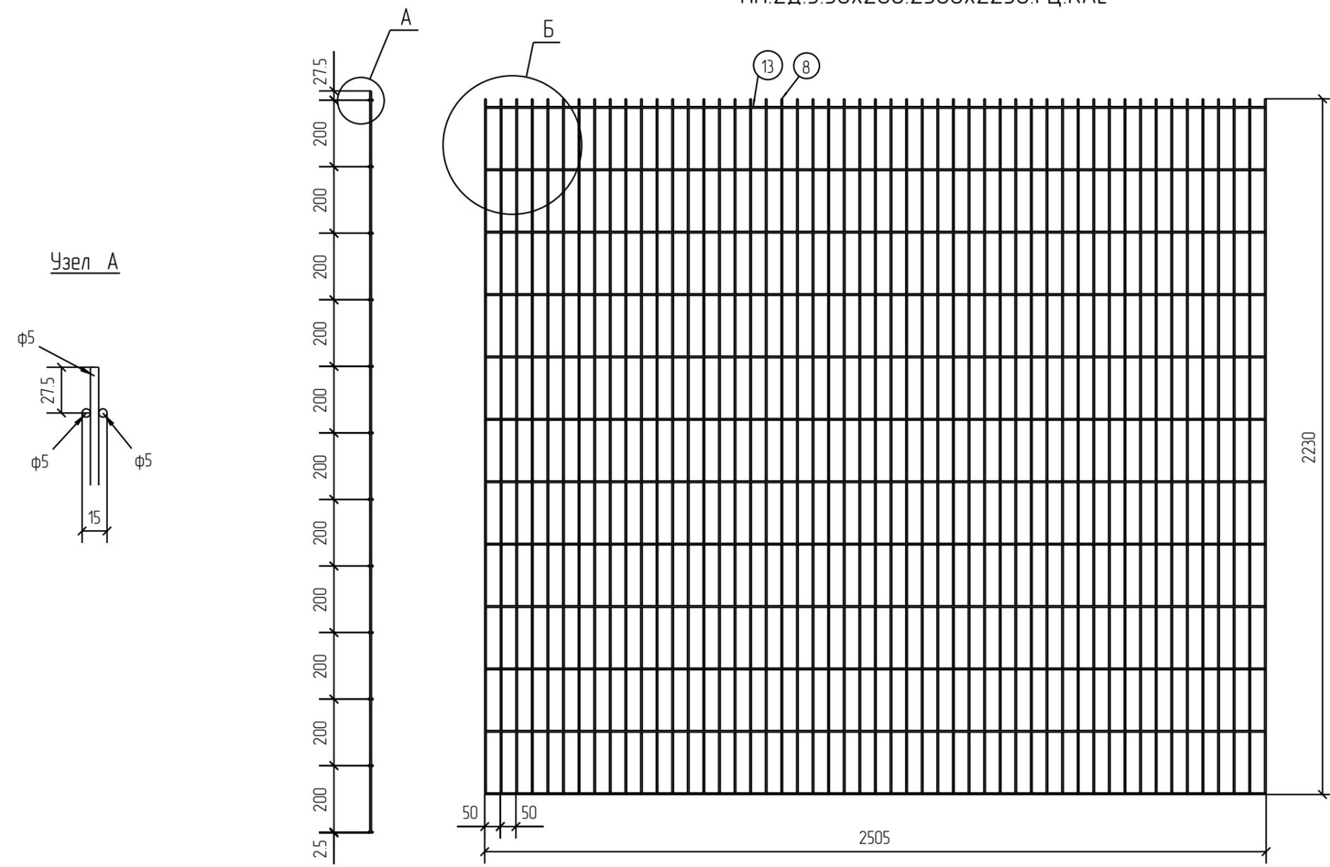
Описание: Панель 2D, из прутка ф 5 мм, двойной горизонтальный пруток, ячейка 50x200 мм по осям прутков, ширина 2500 мм, высота 2230 мм
